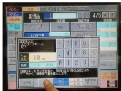
板厚と降伏点応力を入力することにより、圧下表を見ずに圧下量をデータバンクに登録できます。
